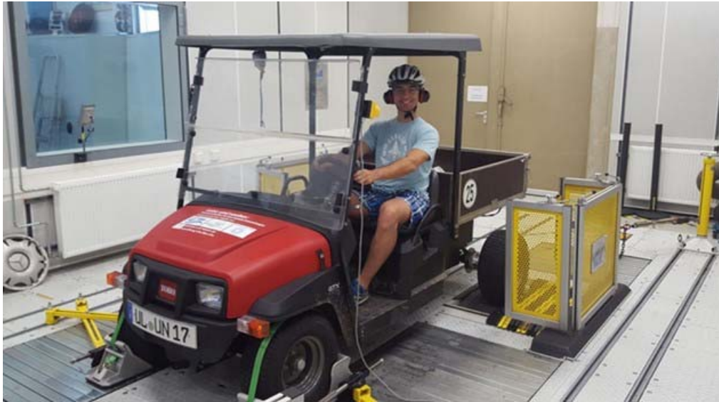
Abbildung 2: Zyklustest (adaptierter NEFZ, wie im Original mit Fahrer) auf dem Rollenprüfstand der HS Ulm
