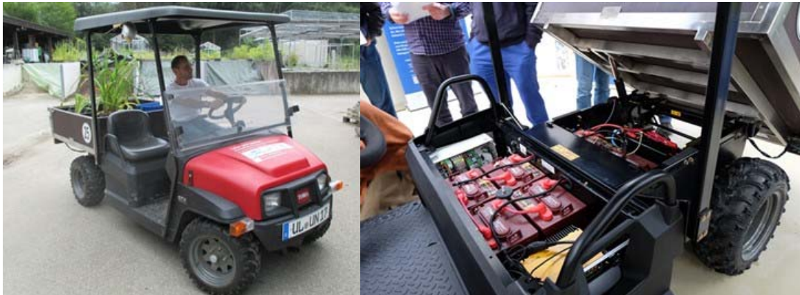
Abbildung 1: Toro Workman GTX mit batterieelektrischem Antrieb. Hinten die Datenerfassungsbox
