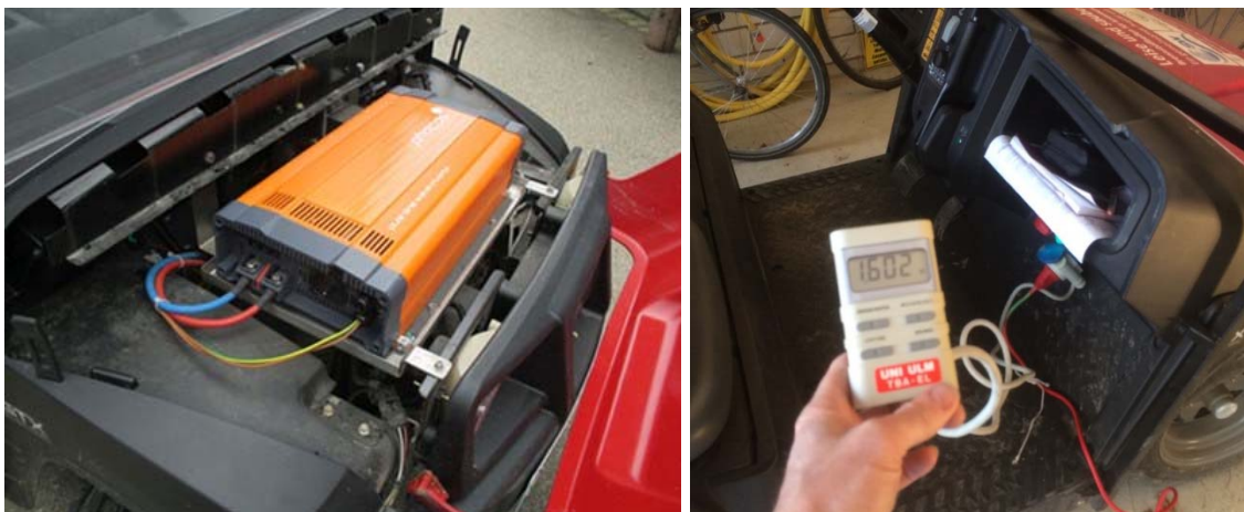
Abbildung 3: "mobile Steckdose" - integrierter DC/AC-Wechselrichter und Steckdose im Fahrgastraum
