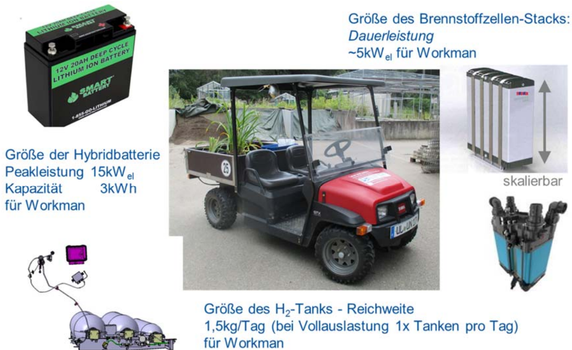
Abbildung 10: Umsetzungsszenario mit Komponenten für Brennstoffzellen-Batterie-Hybridantrieb
