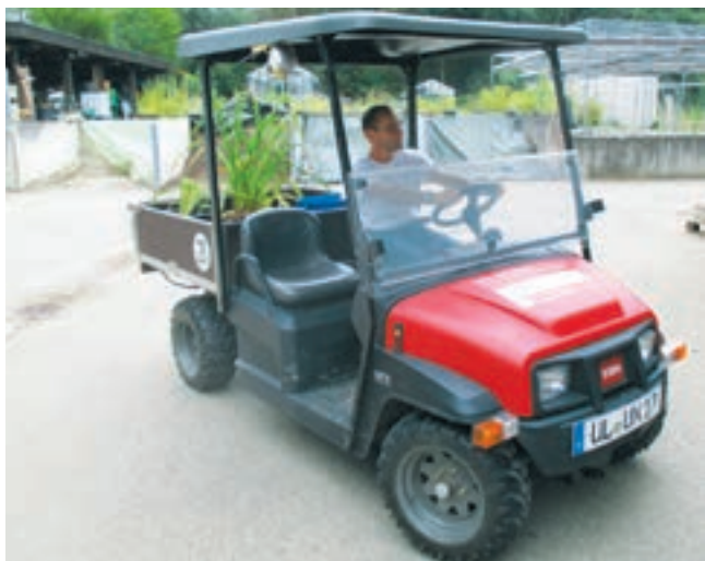
Adaptiertes batterie- elektrisches ATV „Toro Workman“ im Einsatz im Botani- schen Garten Ulm.
