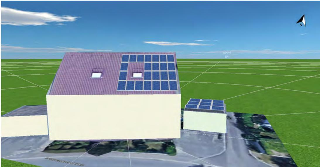
Abbildung 18: 3D-Simulationsmodell des Gebäudes und der Garage. Auf die Modellierung benachbarter Gebäude für die Verschattungsanalyse konnte aufgrund der Topographie (abfallendes Gelände, große Abstände, zurückversetzte Nachbargebäude) verzichtet werden.
